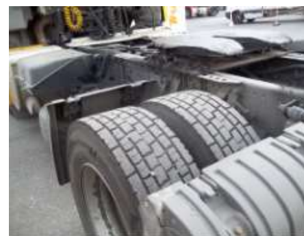
Calotte d'aile arrière manquante : à remplacer
