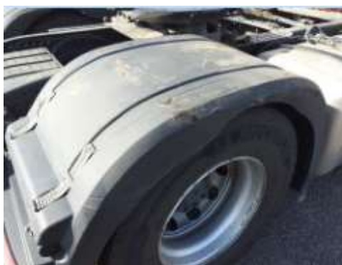
Calotte d'aile arrière frottée : accepté
