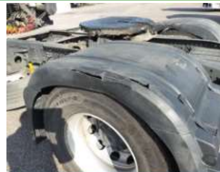
Calotte d'aile arrière perforée : à remplacer
