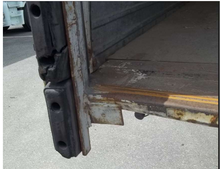
Seuil enfoncé, Butoir endommagé, à réparer
