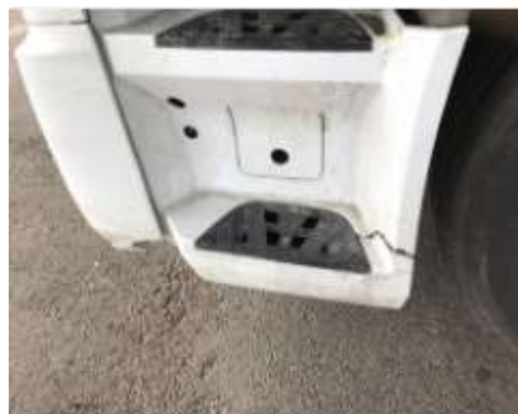
Marchepied fendu : à remplacer
