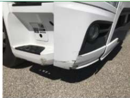
Bouclier avant cassé : à remplacer
