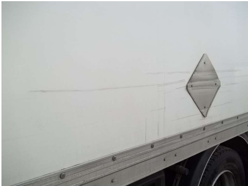
Rayures caisse acceptables
