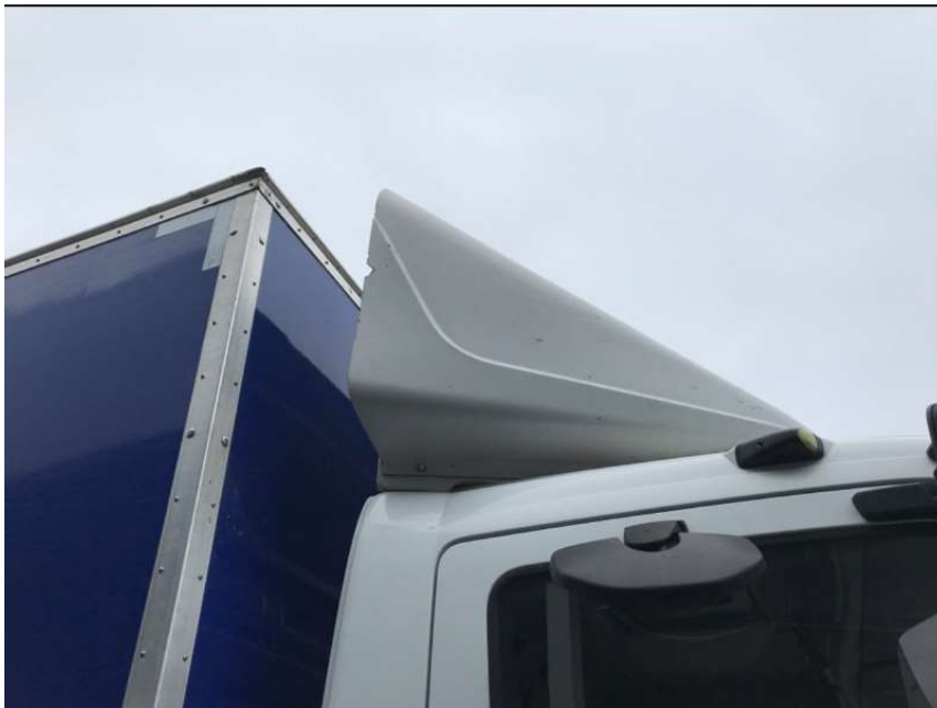
Déflexeur de toit écorné, acceptable
